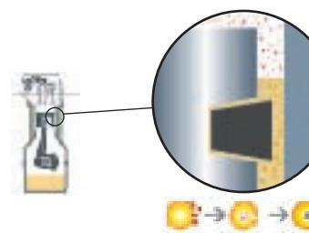
腐食ガスが、ピストンやピストンリングを通る際に、オイルが酸性の腐食ガスを取り込み中和する。
