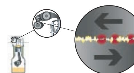
シェルリムラは強靭な油膜とともに、効果的に機能する耐摩耗剤が摺動面に耐摩耗膜をつくり、金属接触の発生を防ぎます。
